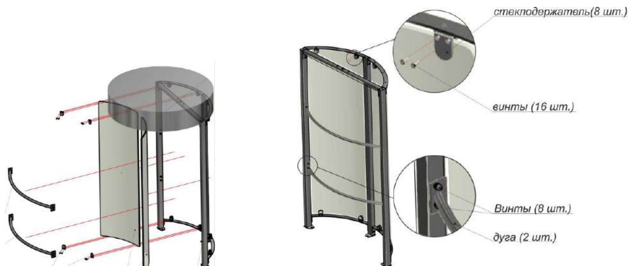
Рис.14- Крепление стекла и дуг стенки ограждения
