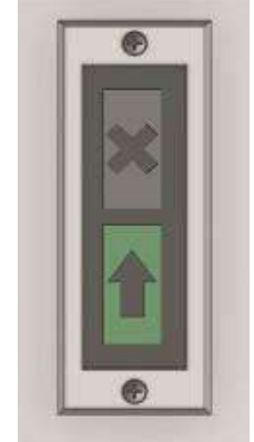
Рис. 3 - Отображения статуса турникета на индикации
